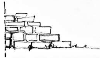
Nella fase di riparazione occorre lasciare le pietre del muro esistente a forma di scaletta per facilitare l'attacco del nuovo muro.
